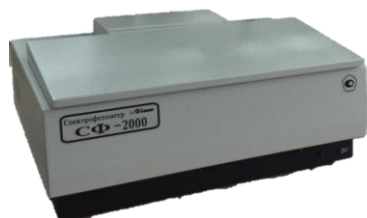
Рисунок 2. Спектрофотометр СФ-2000 (ООО «ОКБ Спектр», Россия)
